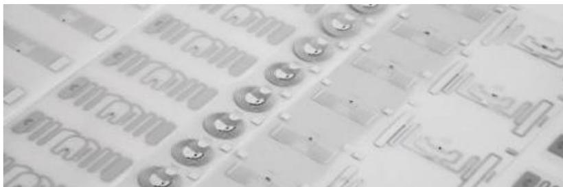
Il tag è un microchip bidimensionale (apposto a supporti diversi a seconda dell'uso) che, sfruttando l'induzione elettromagnetica, sollecitato da un reader RFID attiva un processo di comunicazione e di scambio dei dati in lettura e scrittura.
