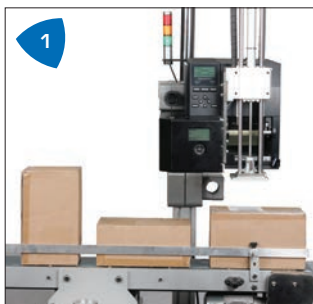
1 Etichettatura in movimento di prodotti di diverse dimensioni fino a 30 etichette al minuto.
